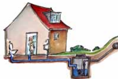
Eksempel på pumpebrønd
